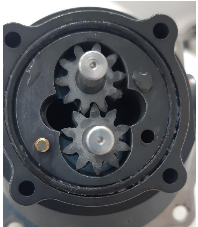
Figura 1. Aspas de engranaje del motor de presión del líquido dializado. El área de fricción ha provocado un socavamiento en la base
